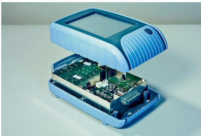
20-р зураг: Хүний амьсгалаас гарах үнэрийг танин өвчин тодорхойлох Nanonose (нанохамар) төхөөрөмж
